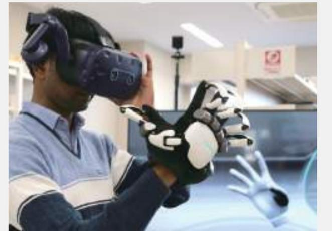
ウェアラブルロボットグローブVRで操作を行い触覚がフィードバックされます
