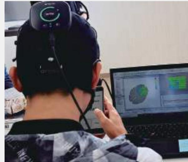
頭につけた28個のセンサーで血中酸素濃度を測って、脳のどこが反応しているかを調べる
